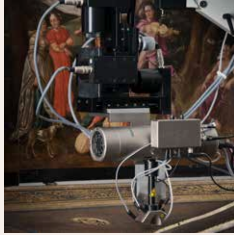
Een Artax micro-XRF-toestel bestemd voor de analyse van pigmenten uit de versiering op het klankblad en de klankkast van de Ruckers-instrumenten. Analyses uitgevoerd door Steven Saverwyns en Marina Van Bos van het KIK. © mim
